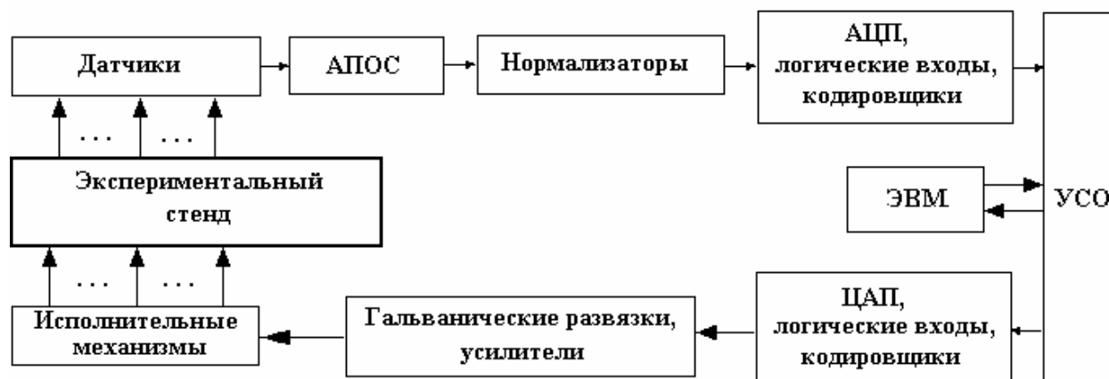
Рис. 1. Функциональная схема организации связей экспериментальной установки с ЭВМ
